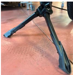
Figura 14 – Cavalletto con le gambe laterali di appoggio più lunghe.
